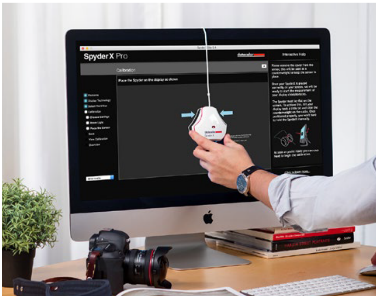
使用色度计进行基于硬件的显示器校准
